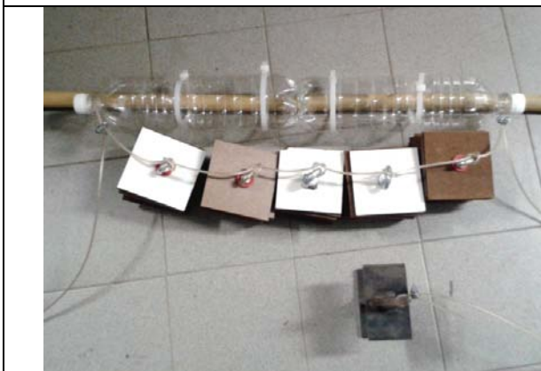
Fig. 18: collegamento dei substrati al galleggiante
