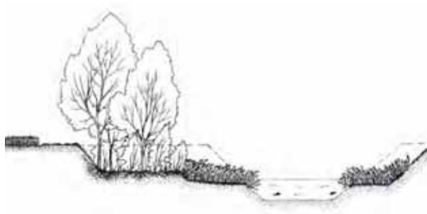
Figura 4 Esempio Schema attuativo dell'intervento di sbancamento naturaliforme di una sponda
