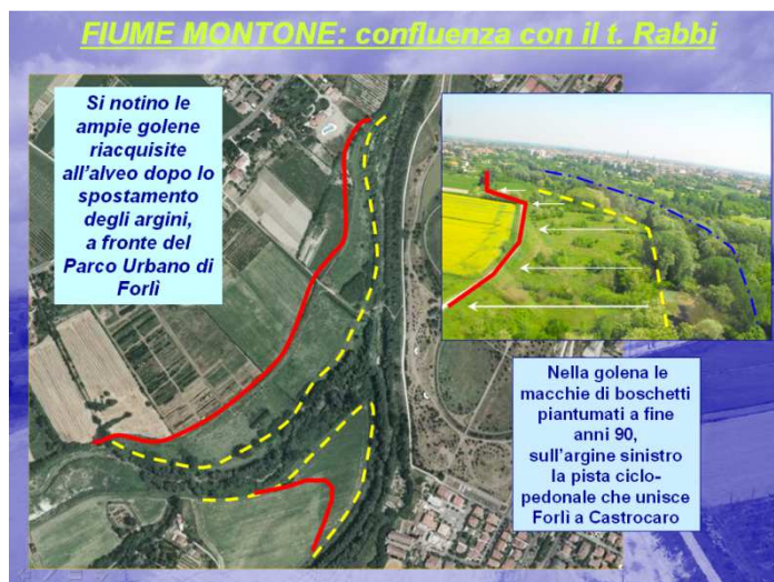
Figura 10 Immagine relativa agli ampliamenti sul fiume Montone, si notino le ampie golene riacquisite all'alveo (giallo tratteggiato: argini demoliti; rosso: nuovo argine) dopo lo spostamento degli argini, a fronte del Parco Urbano di Forlì
