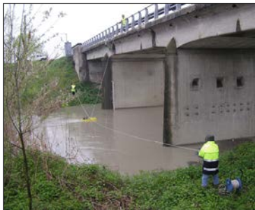
Figura 37 Misure di portata sul ponte Braldo a Forlì con sistema RIVER CAT
