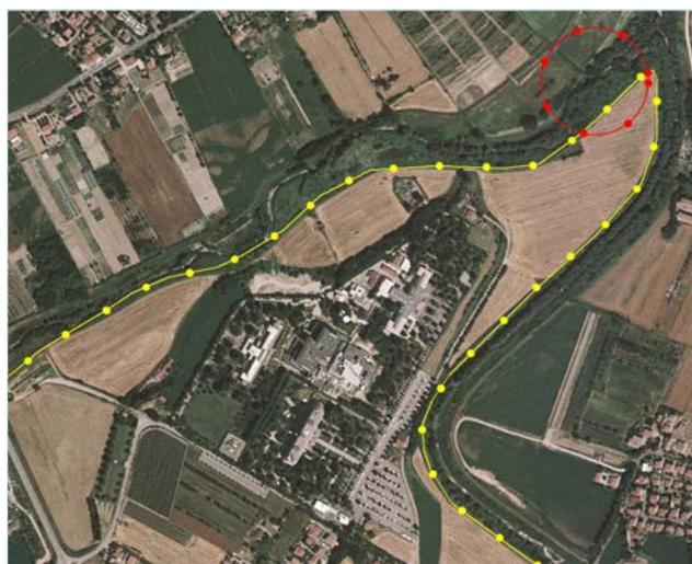
Figura 4 - in giallo gli argini rimossi in una foto da satellite del 2002
