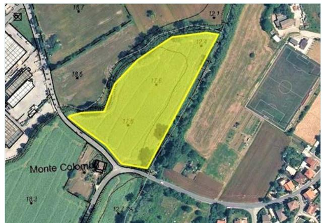
Figura 23 - Area di laminazione/decantazione in località Montecolombo sul torrente Tavollo
