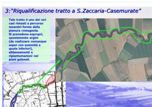
Figura 11 - Meandri da mantenere e nuovi argini da realizzare
