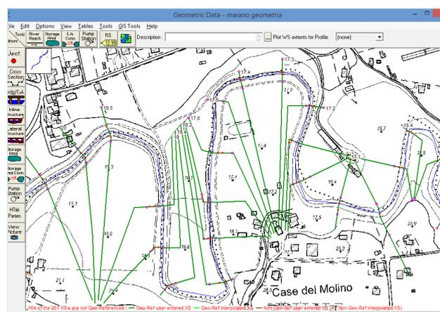
Figura 18: Esempio di definizione geometrica di un tratto a meandri del t. Marano
