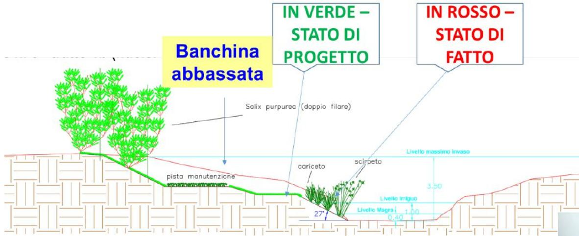
Ampliamento di sezione mediante abbassamento della banchina interna e riprofilatura della sponda (golena allagabile ricreata di circa 1,2 ha su 1 km di canale)
