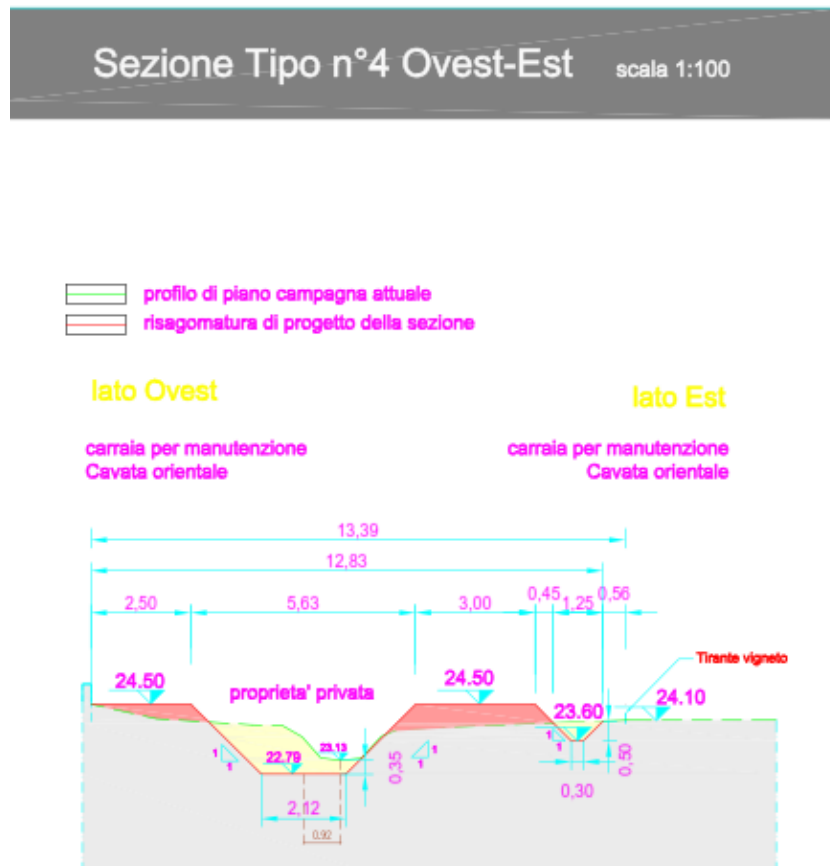
Figura – Sezione tipologica di progetto relativa al tratto 3. La linea verde indica la sezione rilevata nello stato attuale, quella rossa la sezione di progetto, mentre l'area gialle indica la sezione di sbancamento e quella rossa la sezione di riporto.
