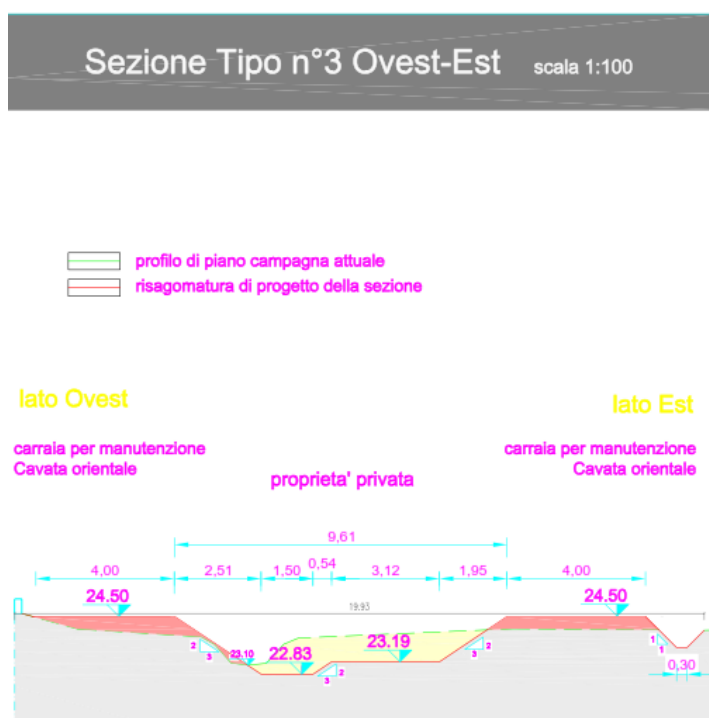
Figura – Sezione tipologica di progetto relativa al tratto 1. La linea verde indica la sezione rilevata nello stato attuale, quella rossa la sezione di progetto, mentre l'area gialla indica la sezione di sbancamento e quella rossa la sezione di riporto.
