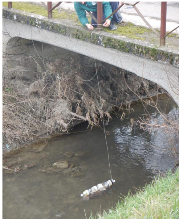
Figura 6 – Substrati artificiali (SA) a lamelle per la cattura dei macroinvertebrati lungo il DFNC
