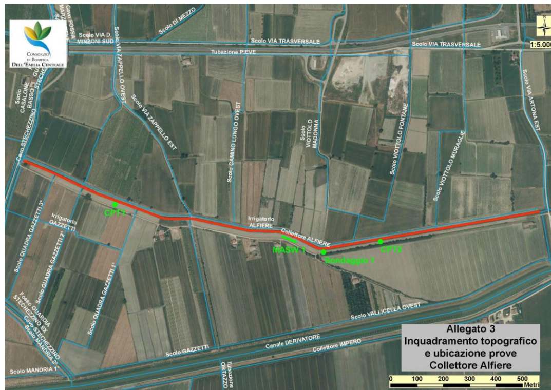
Figura 4 – Ubicazione delle due prova penetrometriche lungo il Collettore Alfieri
