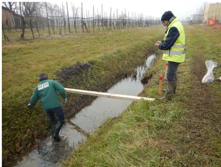
Figura 14 – Fissaggio del SA al palo in legno trasversale al canale lungo la CAVATA ORIENTALE
