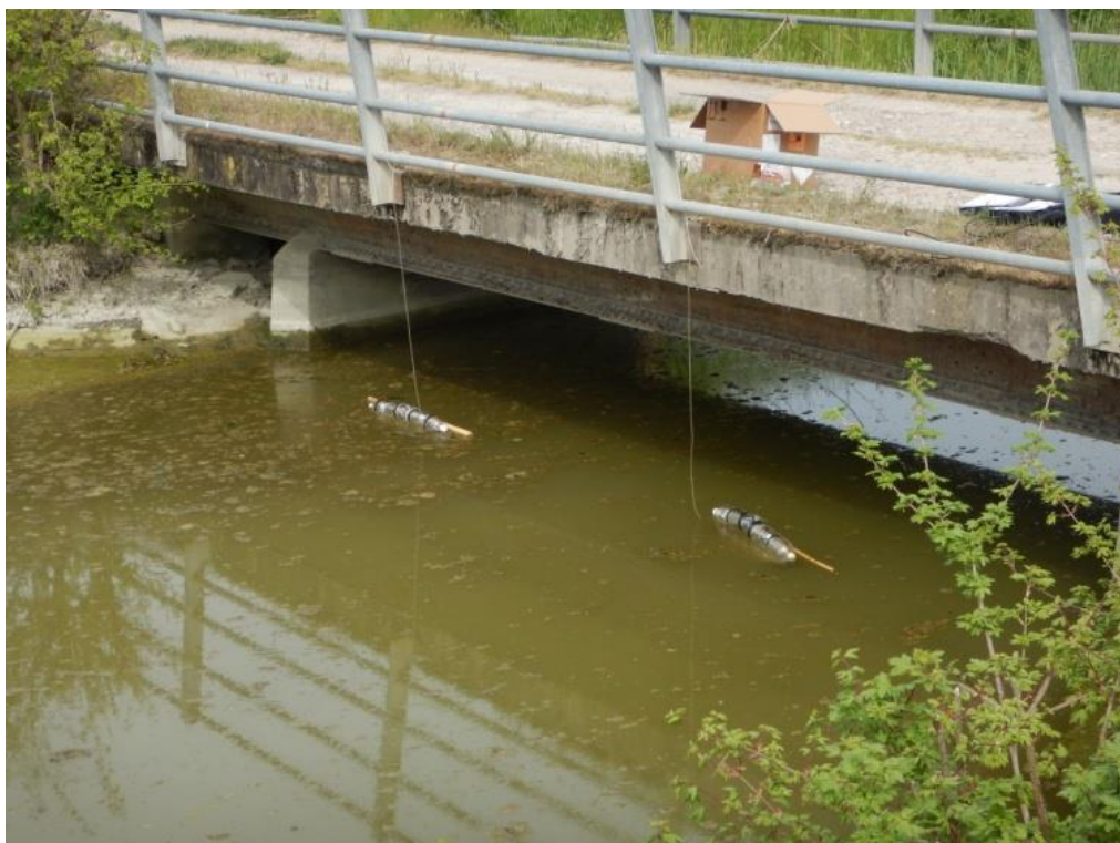
Figura 13 –Substrati artificiali (SA) a lamelle per la cattura dei macroinvertebrati lungo il Collettore Alfieri
