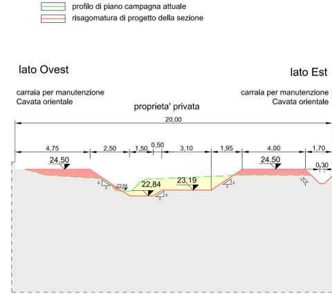
Sezione Tipo n°4 Ovest-Est scala 1:100
