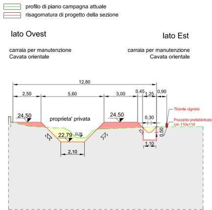
Sezione Tipo n°7 Ovest-Est scala 1:100
