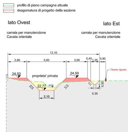
Sezione Tipo n°9 Ovest-Est scala 1:100
