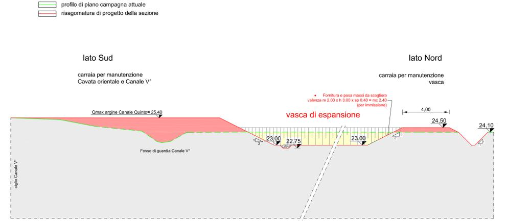
Sezione Tipo n°1 Ovest-Est in corrispondenza dello sfioratore scala 1:100
