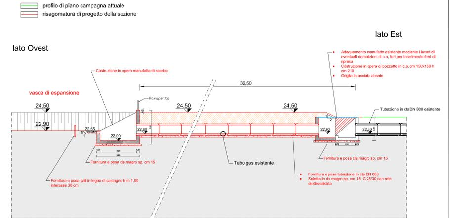
Sezione longitudinale sfioratore e nuova tubazione irrigua scala 1:100
