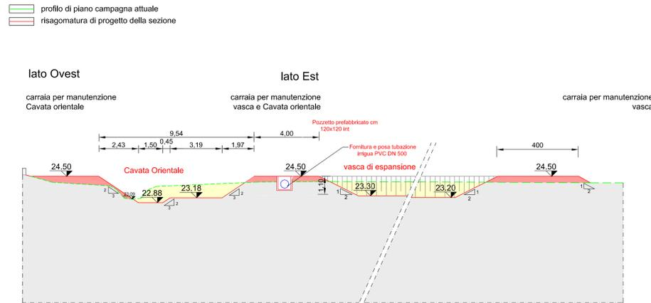
Sezione sbocco cassa e interferenza con tubazione tecnologica gas interrata scala 1:100
