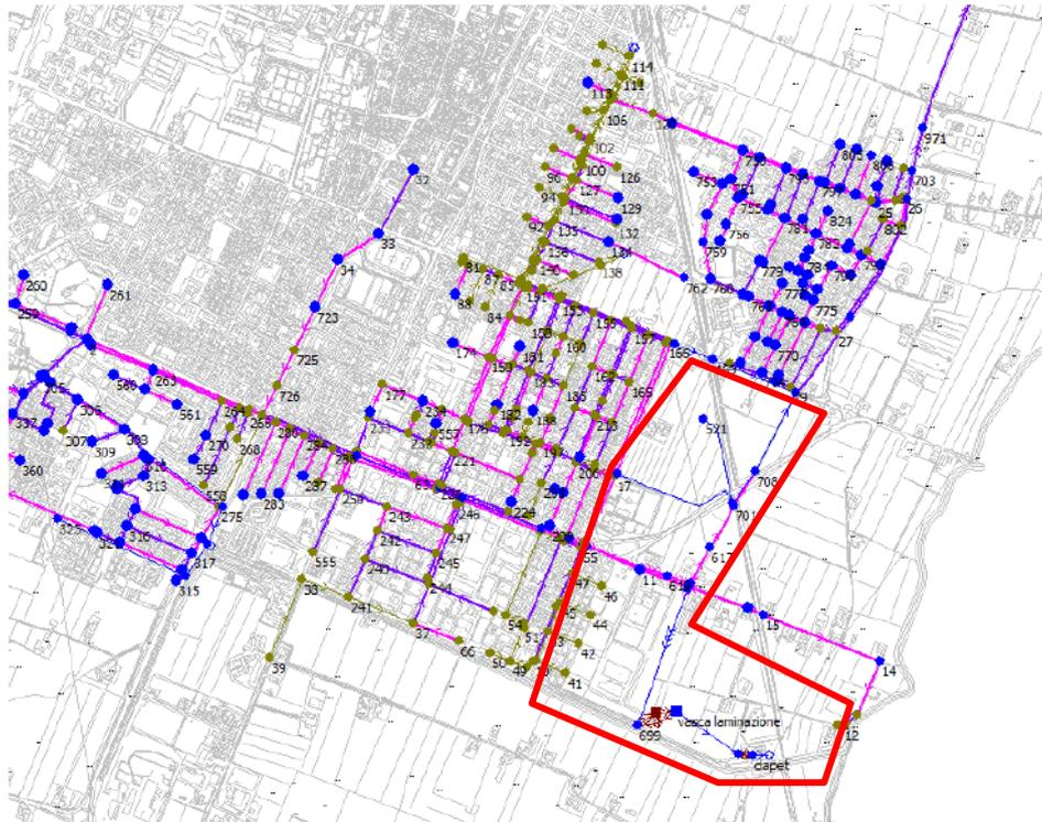
Figura 66: Schema della rete idraulica simulata nel modello di AIMAG SPA. Il riquadro rosso racchiude la porzione di modello che interessa la Cavata Orientale.
