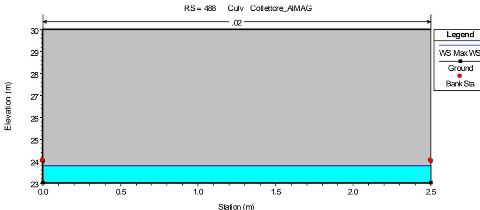
Figura 69: Sezione del nuovo Scolmatore AIMAG SPA in progetto
