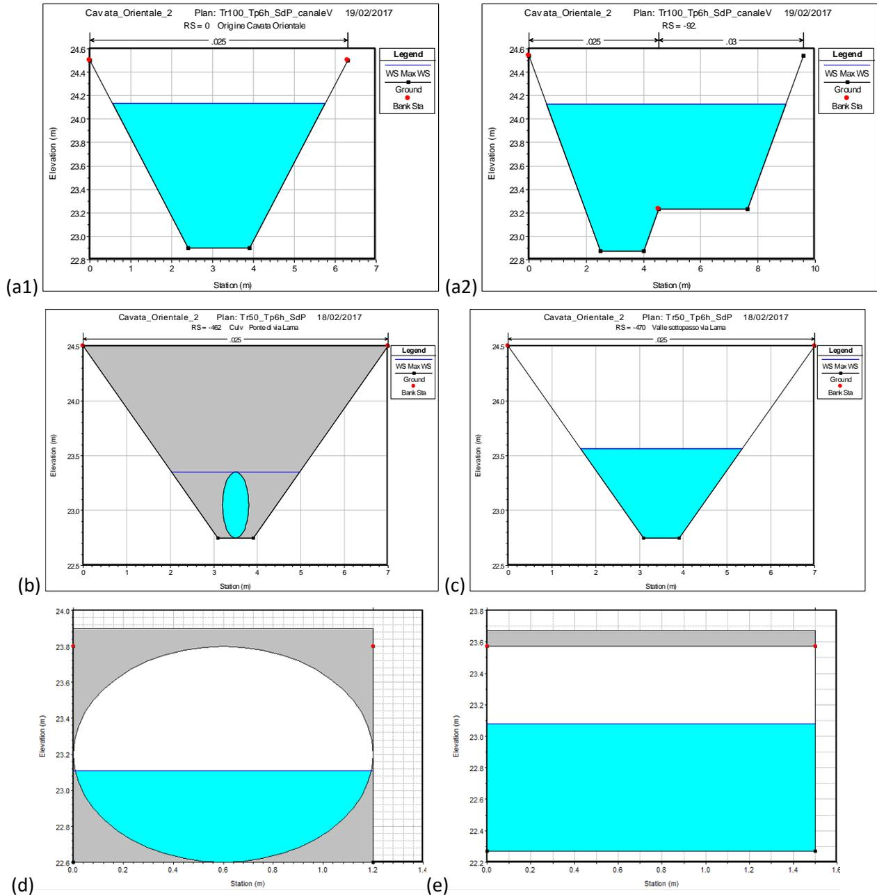
Figura 68: Cavata Orientale: sezioni rappresentative del tratto modellato. (a1) e (a2) sezioni di progetto a monte di via Lama; (b) restringimento a valle dello scolmatore AIMAG mediante una tubazione Dn600; (c) sezione trapezia a valle di via Lama con larghezza del fondo di 80 cm e pendenza delle sponde 1V/1H; (d) tubazione Dn1200 che sottopassa la ferrovia; (e) prosecuzione del tratto tombato con scatolari 150 x 130 cm.
