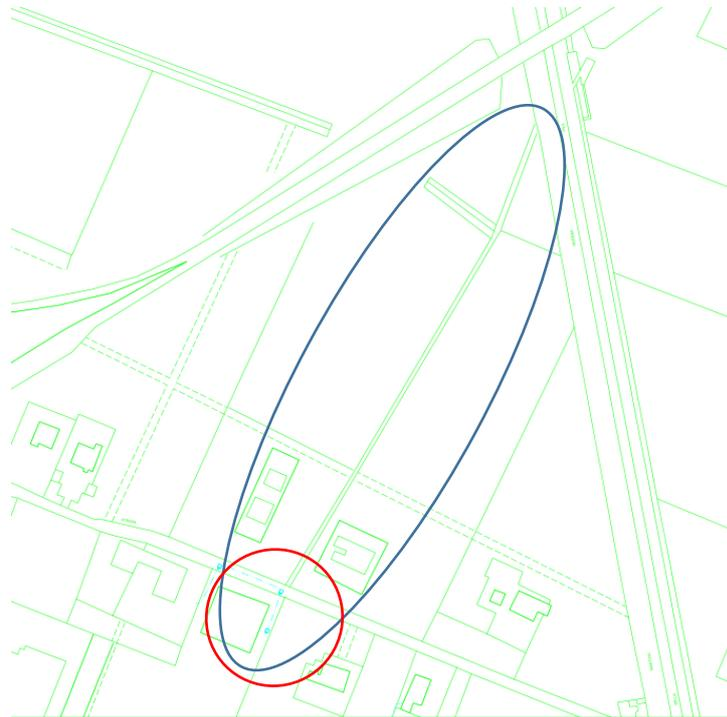
**Figura 87 – Tracciato della rete telefonica (in azzurro) nell’area di intervento (indicata in blu), con indicazione della possibile interferenza in sinistra idraulica del canale Cavata Orientale (in rosso)**
