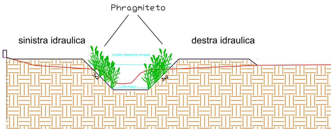
Figura 43 – Sezione tipologica di sbancamento relativa al tratto 1 a cui è applicato un assetto vegetazionale di progetto
