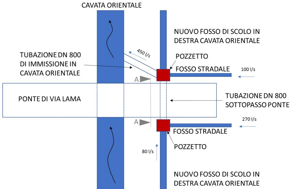
Figura 62 – Schema di sottopasso del nuovo fosso di scolo al di sotto del ponte di via Lama
