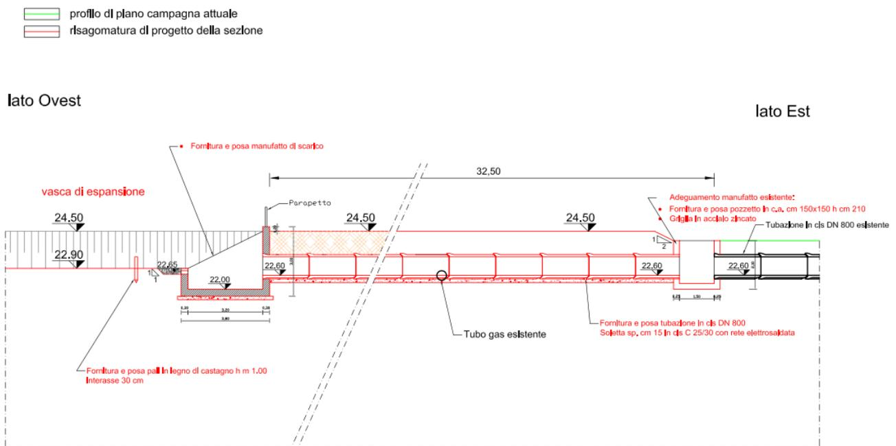
Figura 52 - Manufatto di scarico della cassa di espansione
