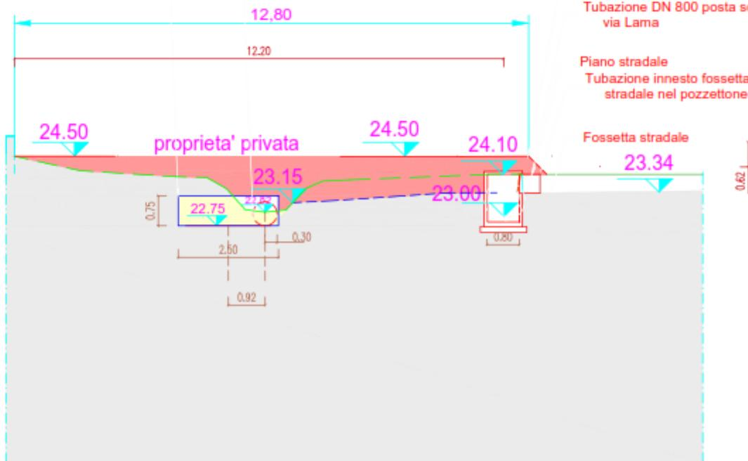
Figura 42 – Traslazione verso ovest dell'asse del canale.
