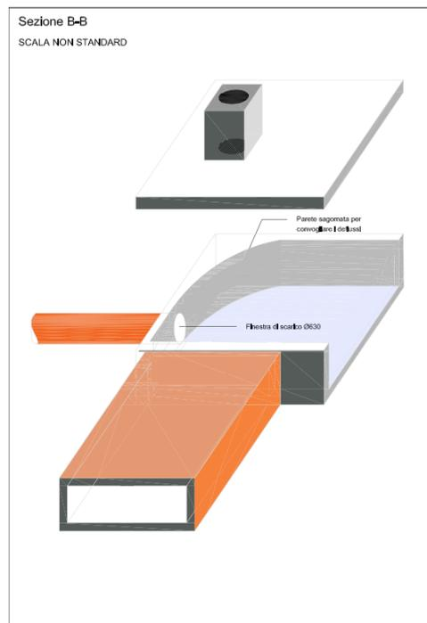
Figura 25 – Particolare costruttivo dell'immissione dello scolmatore (in arancione) in Cavata Orientale; si noti la parete sagomata per convogliare i deflussi verso monte nel canale Cavata Orientale e la finestra di scarico di diametro 600 mm posizionata in Cavata Orientale per limitare le portate scolanti verso valle
