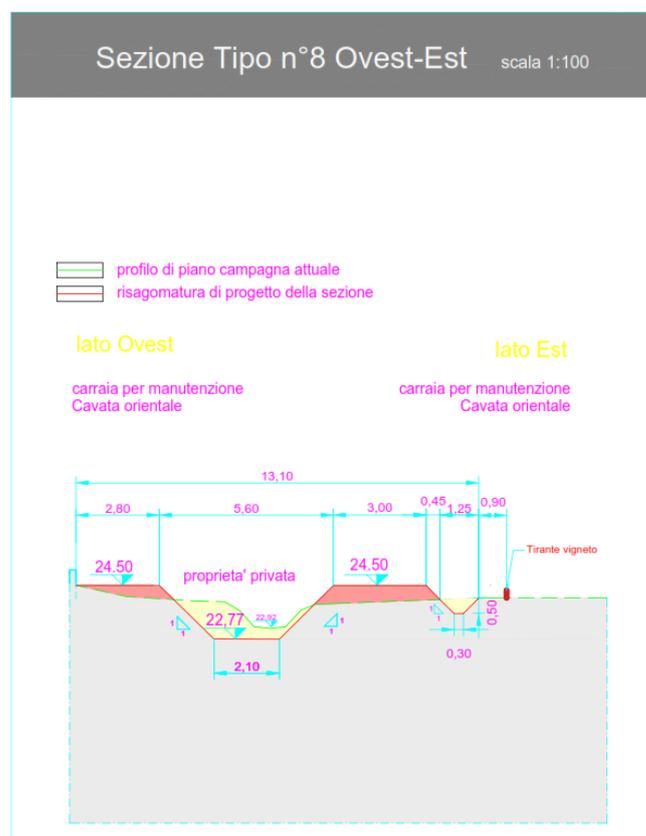
Figura 40 – Sezione tipologica di progetto relativa al tratto 3. La linea verde indica la sezione rilevata nello stato attuale, quella rossa la sezione di progetto, mentre l'area gialle indica la sezione di sbancamento e quella rosa la sezione di riporto.
