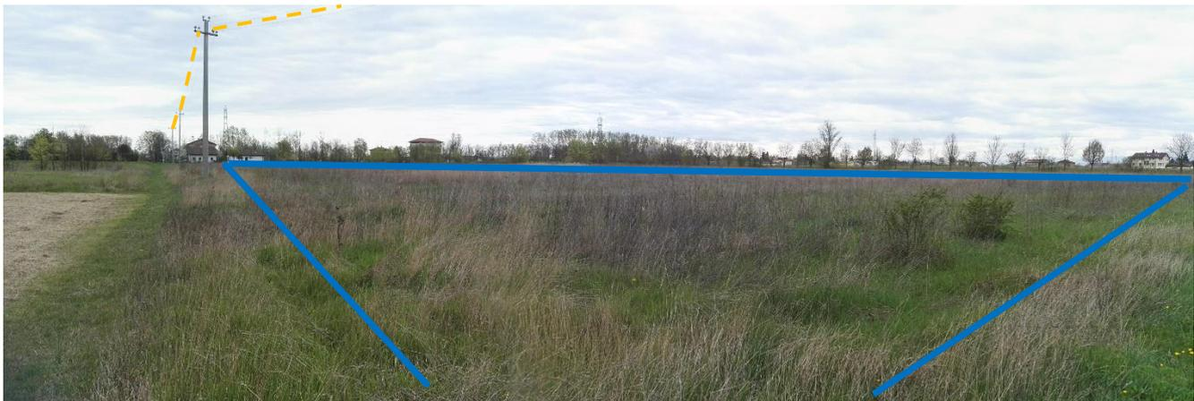
Figura 85 – Nella foto in alto: tracciato della linea elettrica aerea (in arancione) e interrata (in rosso) e indicazione degli argini della cassa (in blu). Nella foto in basso: la medesima linea elettrica aerea in corrispondenza del sito di costruzione dell'argine nord della cassa di espansione; in arancione la linea aerea, in blu il tracciato indicativo dell'argine della cassa, che mostra come non vi sia interferenza.
