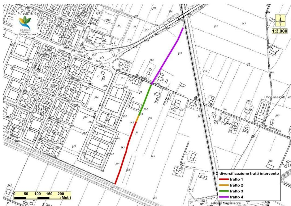
Figura 36 – Intervento di ampliamento di sezione della Cavata Orientale: tratto 1 (ampliamento mediante creazione di una banchina allagabile), tratto 3 (ampliamento a sezione trapezia), tratto 2 di raccordo morfologico, tratto 4 di approfondimento del fondo.
