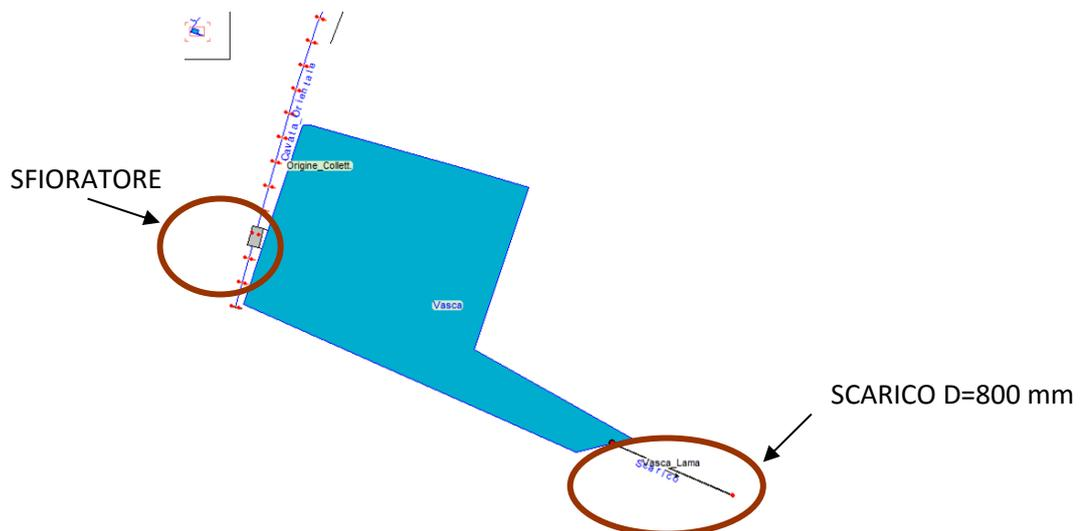
Figura 70: Dettaglio dello schema della vasca di laminazione, dello sfioratore e dello scarico nel Canale V.
