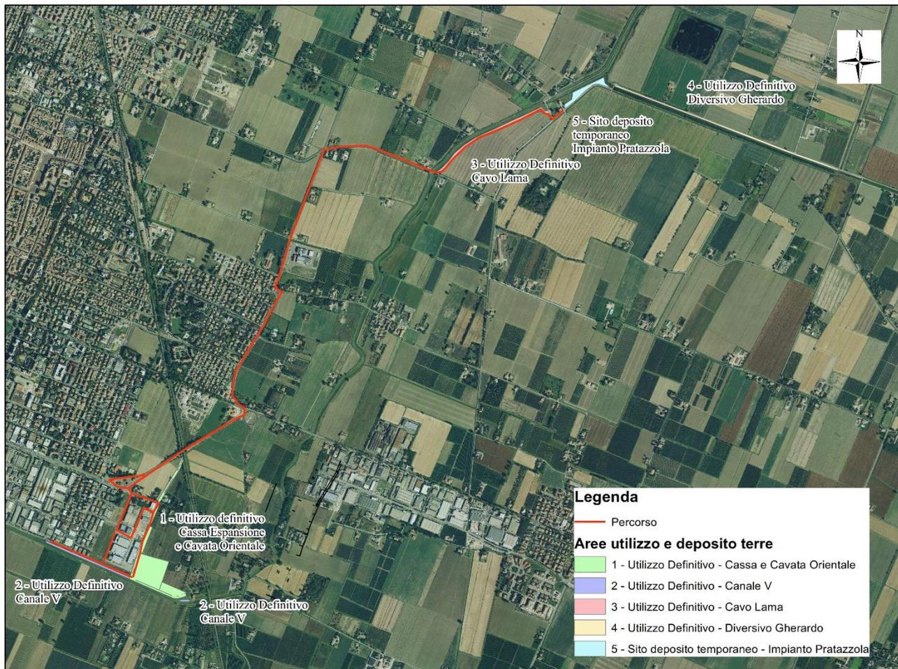
Figura 89 – Visione di insieme dell'area della Cavata Orientale, dei siti di stoccaggio temporaneo delle terre da scavo e dei siti di utilizzo definitivo. In rosso sono indicati i percorsi di trasporto individuati in fase preliminare.
