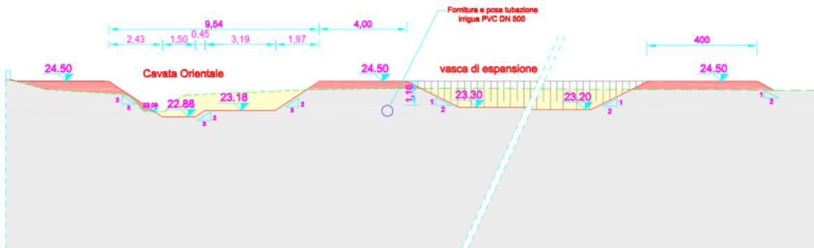
Figura 54 – Sezioni tipologiche di progetto della Cassa di espansione a servizio della Cavata Orientale (sezioni indicate in Figura 34)
