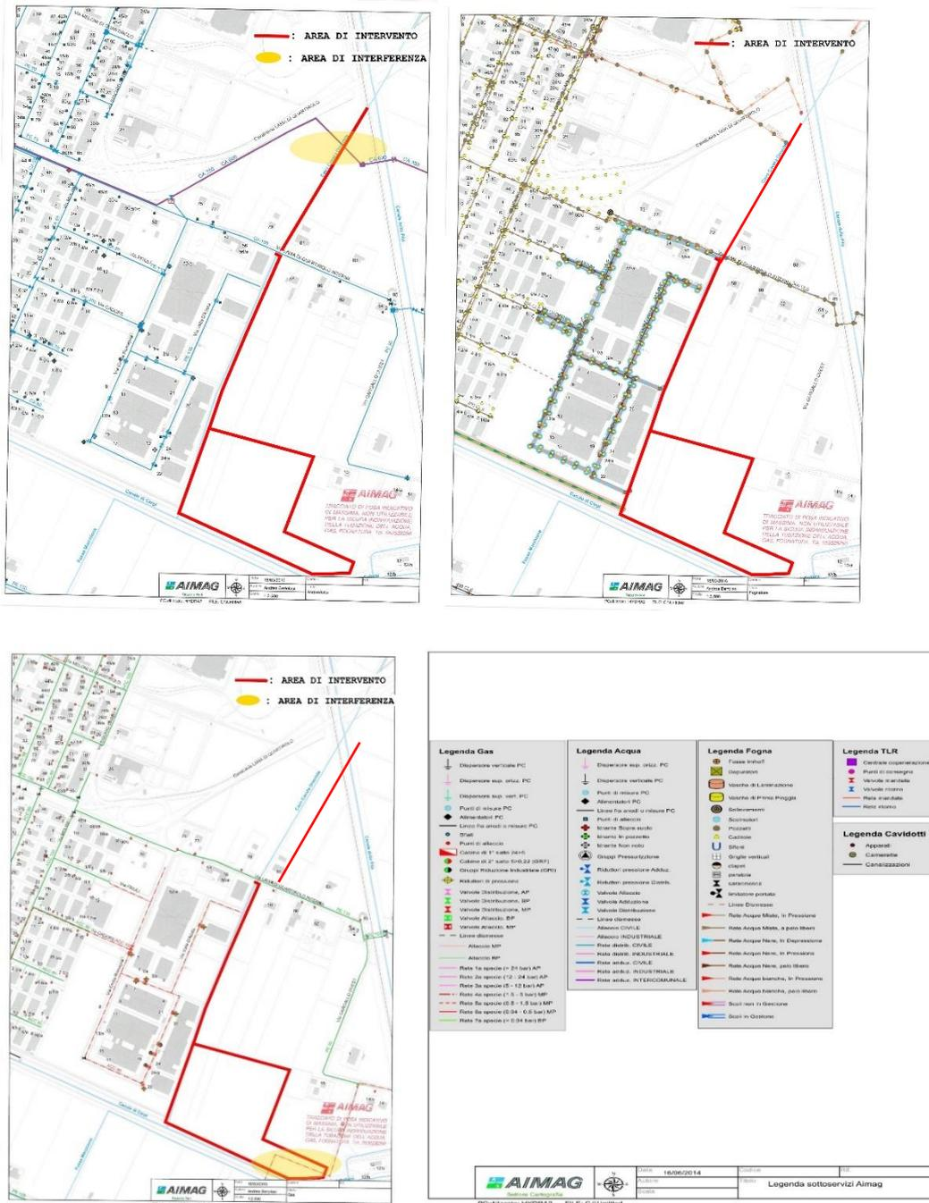
Figura 81 – Indagine delle interferenze con le reti di servizi (nella figura in alto è rappresentata in giallo l’area di localizzazione della tubazione dell’acqua, mentre nella figura in basso è localizzata l’interferenza con la tubazione del gas)
