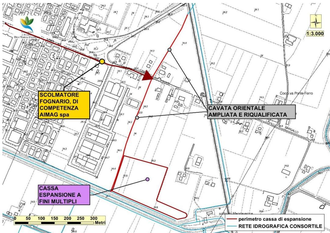
Figura 33 – Localizzazione degli interventi lungo la CAVATA ORIENTALE che vanno a costituire il “nodo idraulico” complessivo: Scolmatore su via Lama (di competenza AIMAG SPA), CAVATA ORIENTALE AMPLIATA E RIQUALIFICATA e CASSA DI ESPANSIONE a fini multipli (di competenza del Consorzio di bonifica dell’Emilia Centrale)
