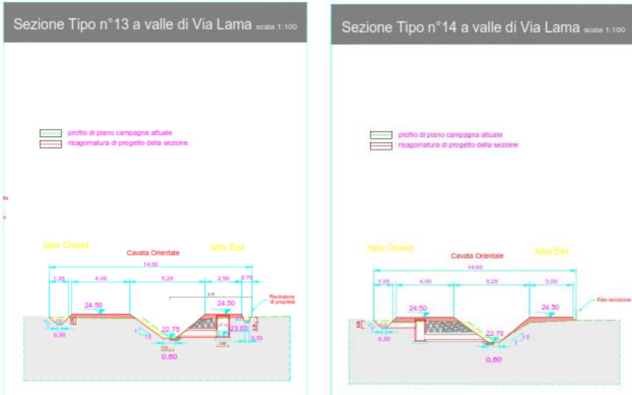
Figura 44 – Sezioni tipo di progetto nel tratto 4, a valle di via Lama
