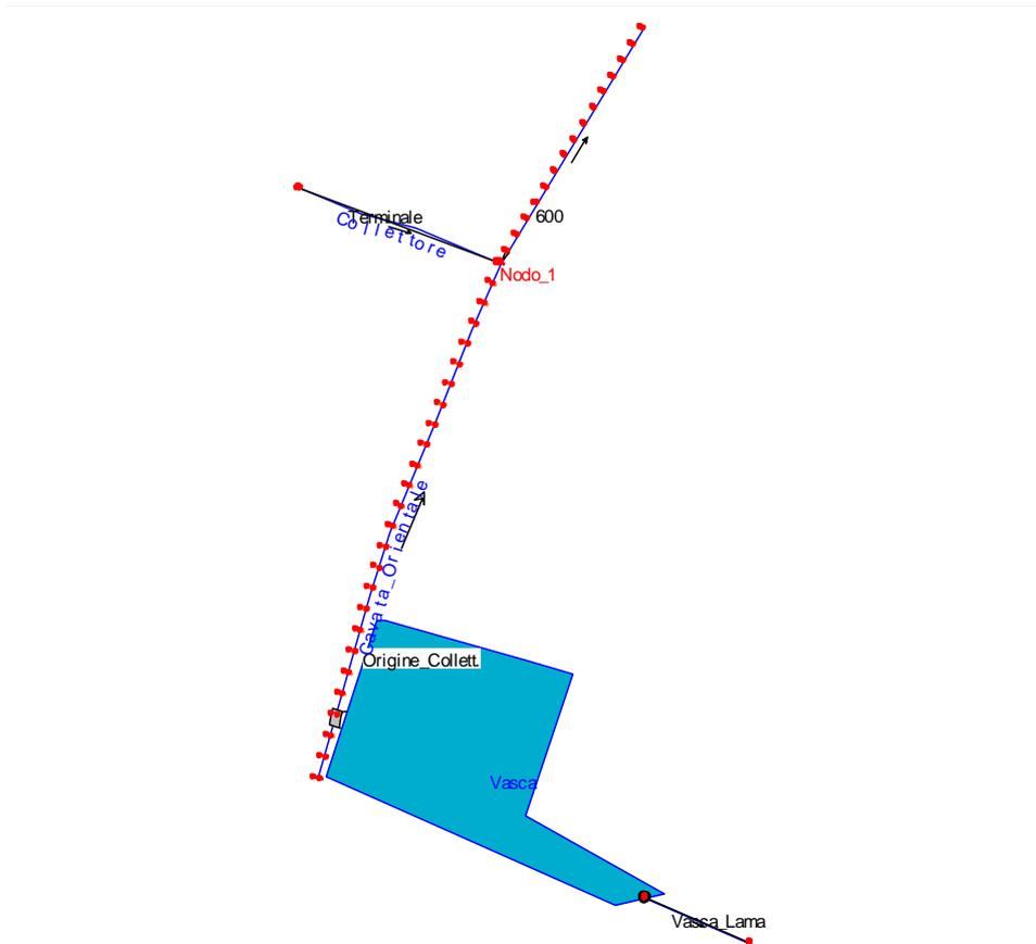
Figura 67: Modello HEC-RAS per la simulazione del funzionamento del sistema Scolmatore AIMAG SPA-Cavata Orientale-cassa di espansione
