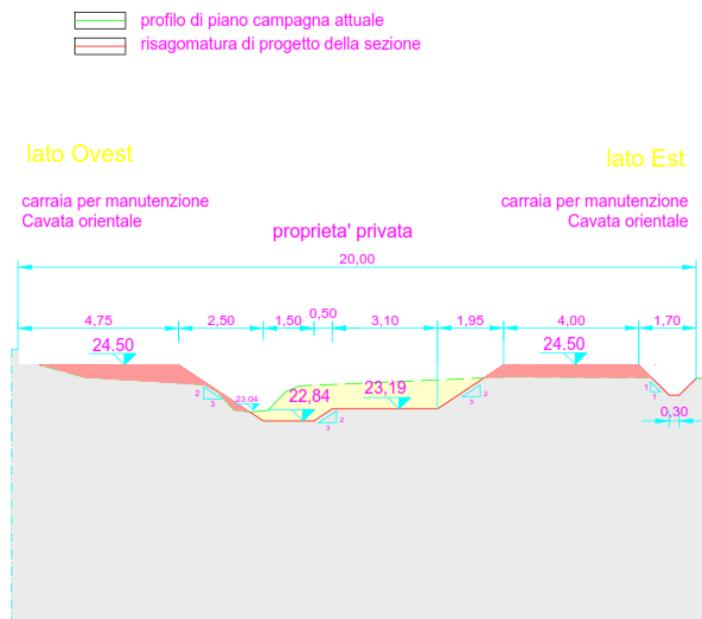
Figura 38 – Sezione tipologica di progetto relativa al tratto 1. La linea verde indica la sezione rilevata nello stato attuale, quella rossa la sezione di progetto, mentre l'area gialla indica la sezione di sbancamento e quella rossa la sezione di riporto.
