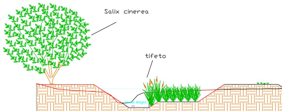
Figura 39 – Sezione tipologica di sbancamento relativa al tratto 1 a cui è applicato un assetto vegetazionale di progetto
