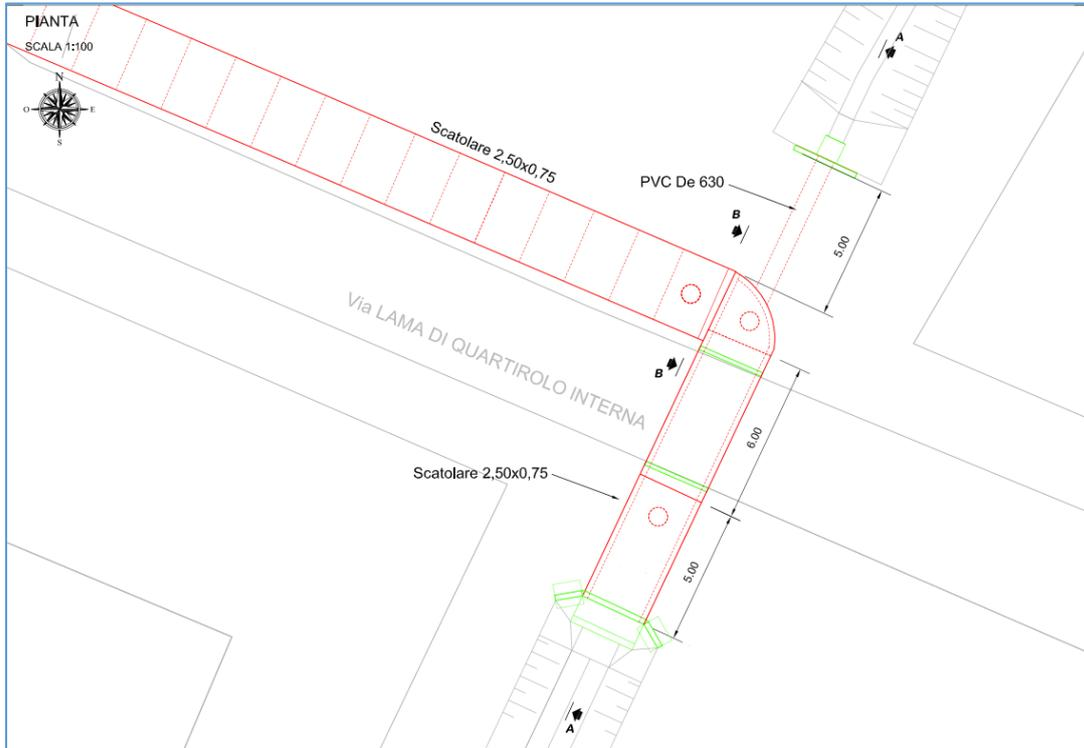
Figura 24 – Planimetria dell'area di immissione dello scolmatore AIMAG in Cavata Orientale
