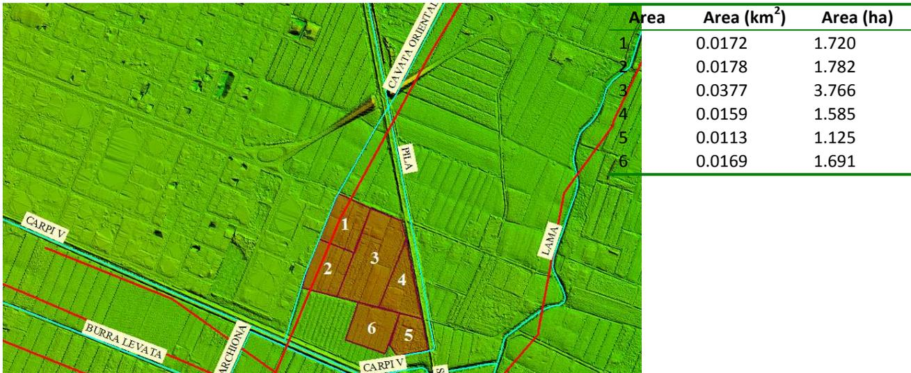
Figura 14: Aree afferenti alla Cavata Orientale a monte di via Lama. Le linee rosse rappresentano il reticolo modellato con il software SWMM
