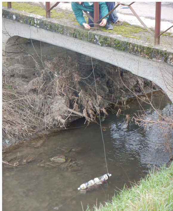
Figura 17 – Substrati artificiali (SA) a lamelle per la cattura dei macroinvertebrati lungo il DFNC
