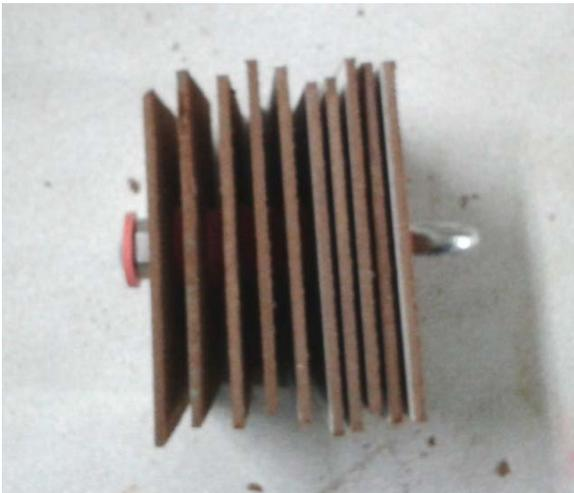
Figura 2 – Singolo SA costituito da lamelle di faesite grezza.
