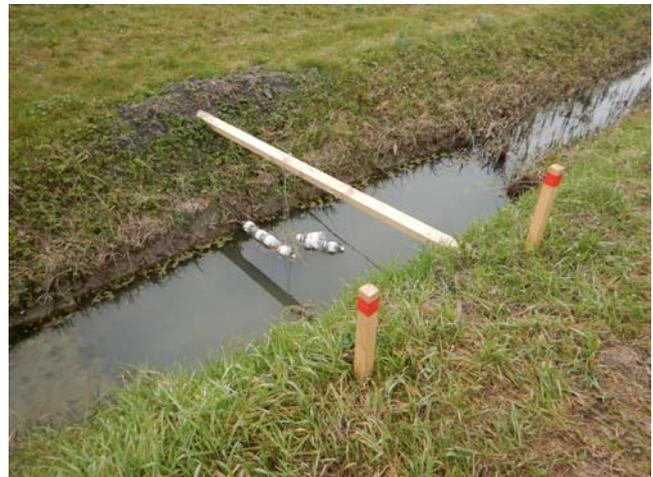
Figura 5 – Fissaggio del SA al palo in legno trasversale al canale. Figura 6 – Substrati ancorati al palo in legno.
