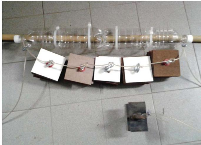
Figura 3 – Strumento assemblato per il campionamento.
