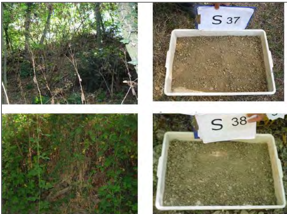
Fig.11 – localizzazione dei sondaggi S37 e S38 e preparazione dei campioni.
