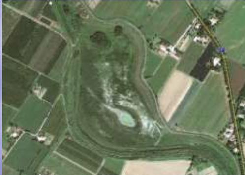
Tramite le servitù e gli accordi di programma attuati si riuscirà ad eseguire le casse di laminazione con una incidenza media di 0,30 € al mc. di acqua stoccata, contro gli 7-8 € a mc. nel caso di espropriazioni e opere canoniche: si avranno così interventi idraulici con una spesa inferiore di 20 volte.
