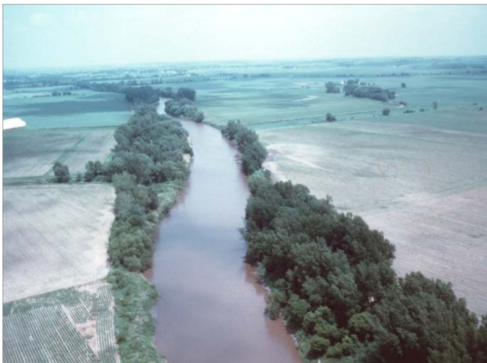
Figura 4.12 – Alveo di tipo sinuoso.
