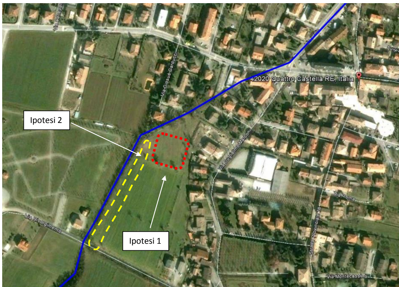
Figura 52 – Ipotesi 1: cassa di espansione (in rosso). Ipotesi 2: allargamento naturalistico di sezione per la laminazione delle piene (in giallo) (la localizzazione indicata è solamente esemplificativa dell'intervento e andrà definita in fase progettuale).
