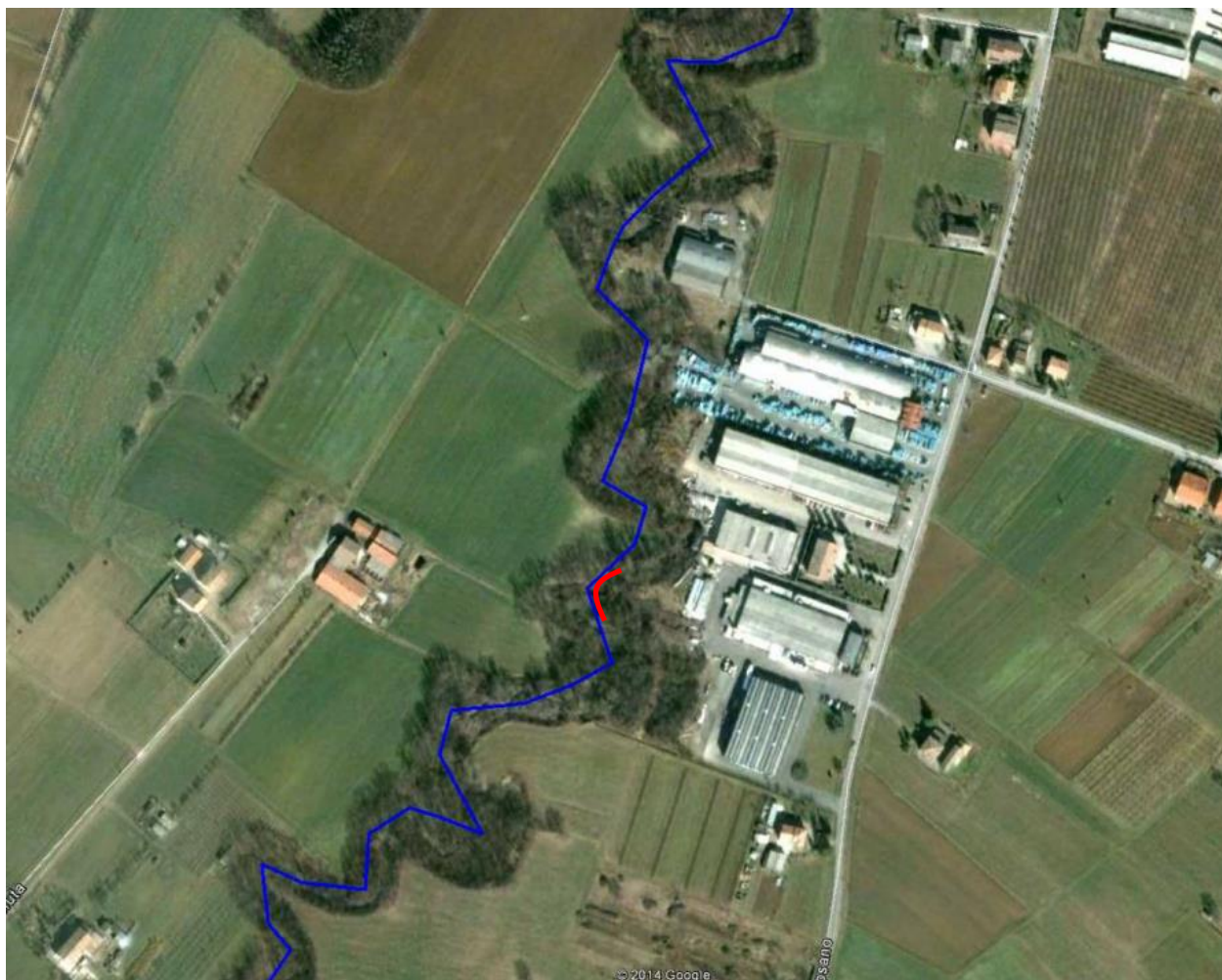
Figura 6 – Palificata viva (in rosso) a protezione della pista ciclabile localizzata a ridosso della sponda in erosione.
