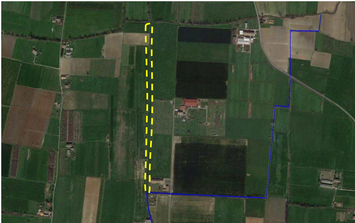
Figura 103 - Creazione di una cassa di espansione mediante scavo del canale abbandonato (linea gialla).
