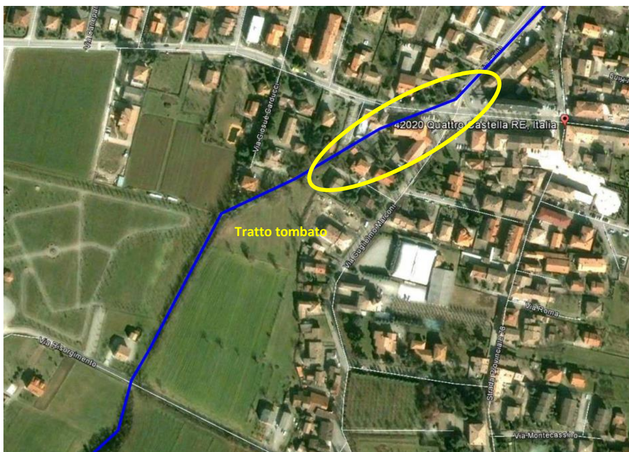
Figura 47 – Punto critico 1 del Rio Monticelli – Tratto tombato.
