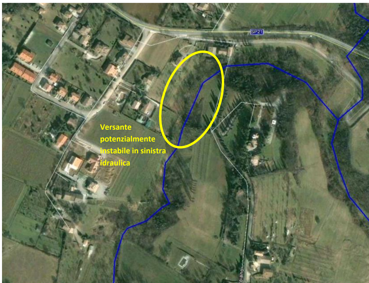
Figura 27 - Punto critico 3 del Rio della Chiesa. Versante potenzialmente instabile in sinistra idraulica.
