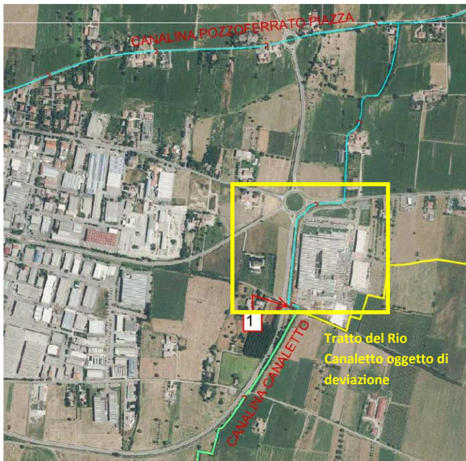
Figura 106 - Punto critico 1 del Rio Canaletto. Si nota, ove indicato con "1", il punto di deviazione del rio con una curva a 90° verso sinistra, al fine di permettere l'edificazione dell'area industriale presente in foto subito a valle della curva.
