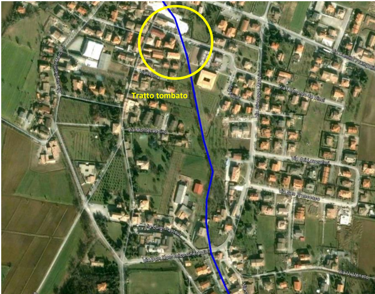
Figura 54 – Punto critico 1 del Rio da Corte – Tratto tombato.
