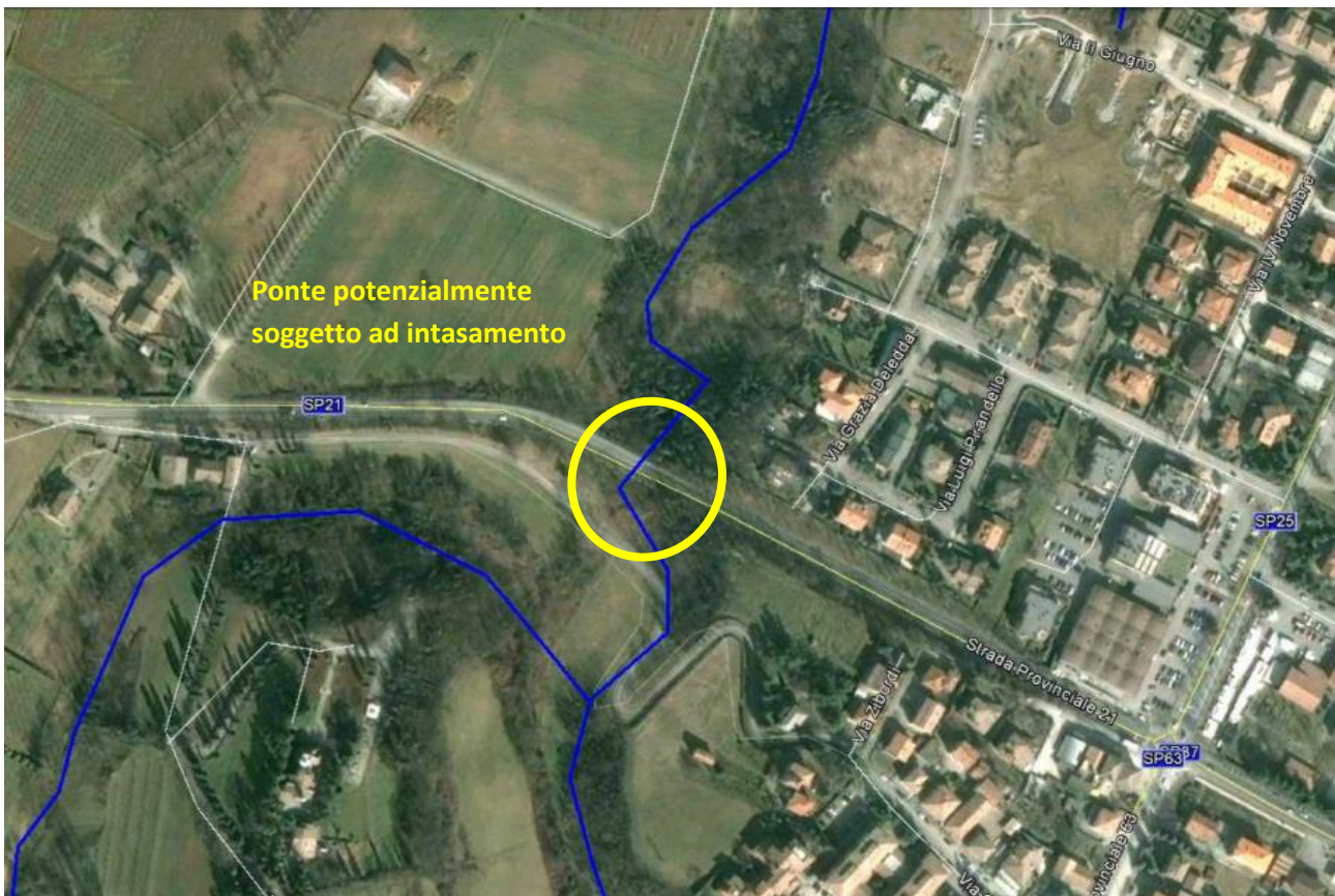
Figura 24 – Punto critico 2 del Torrente Arianna. Ponte potenzialmente soggetto ad intasamento.
