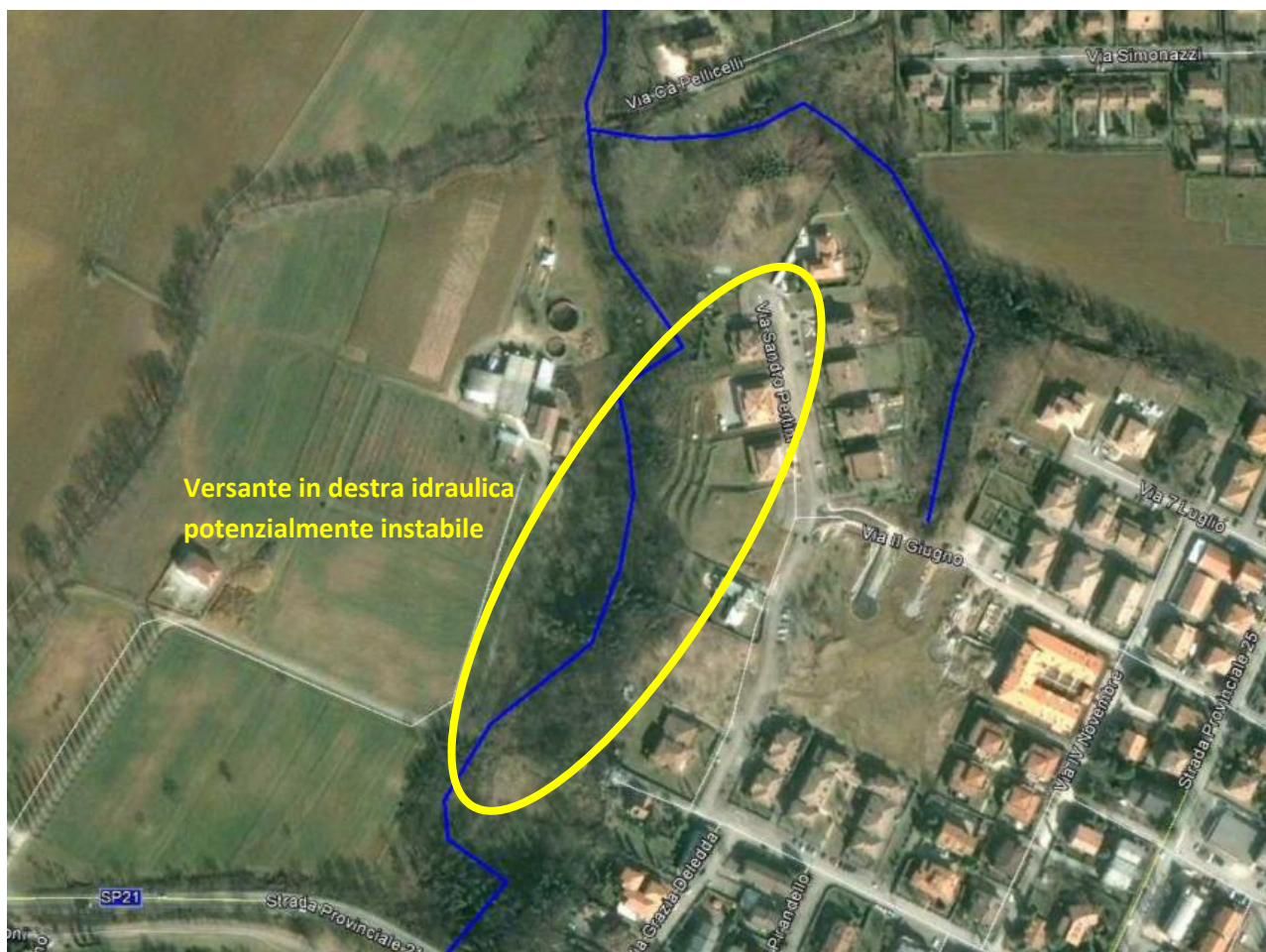
Figura 22 – Punto critico 1 del Torrente Arianna. Versante potenzialmente instabile in destra idraulica.
