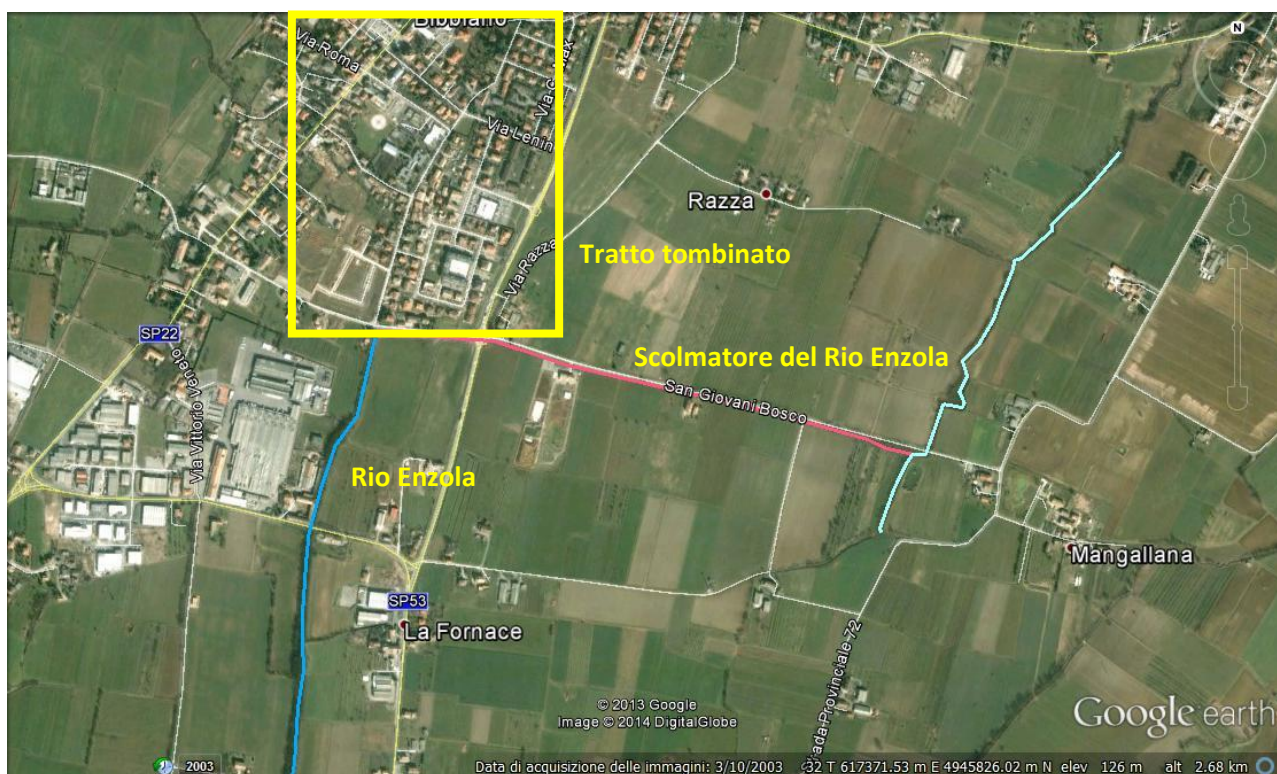
Figura 111 - Punto critico 1 del Rio Enzola. Tratto tombato.
