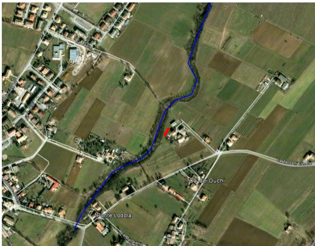
Figura 20 – Consolidamento di fondo e sponde nei pressi del ponte mediante l'uso di tecniche di intervento "classiche" (posa di massi rinverditi) (in rosso).
