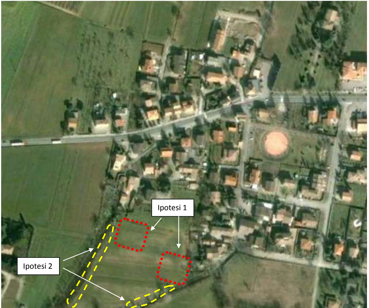
Figura 40 – Ipotesi 1: cassa di espansione (in rosso); Ipotesi 2: allargamento naturalistico di sezione per la laminazione delle piene (in giallo) (la localizzazione indicata è solamente esemplificativa dell'intervento e andrà definita in fase progettuale).
