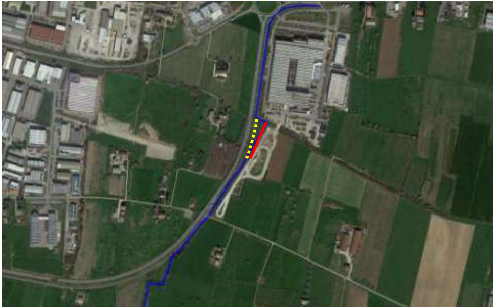
Figura 63 - Allontanamento della corrente dal bene esposto mediante scavo di un nuovo canale principale (in giallo) e ricopratura dell'originario (in rosso), con riforestazione dell'area.
