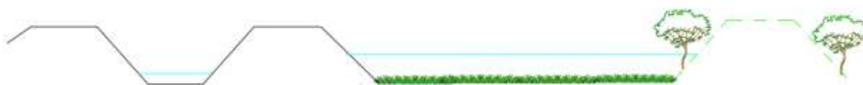
Figura 25 – Schema tipologico di intervento. Laminazione delle piene in un’area adibita all’accumulo delle acque (cassa di espansione).
