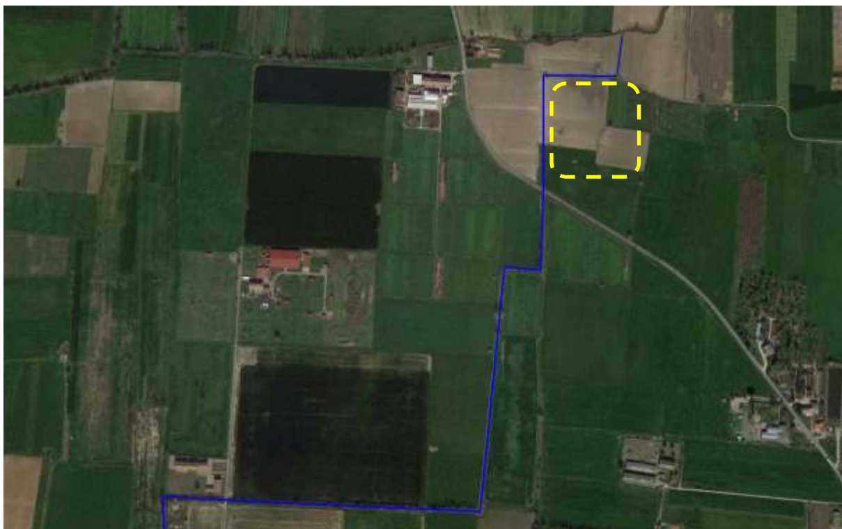
Figura 60 - Laminazione delle piene in un'area adibita all'accumulo delle acque, "acquisita" mediante servitù idraulica (in giallo)
