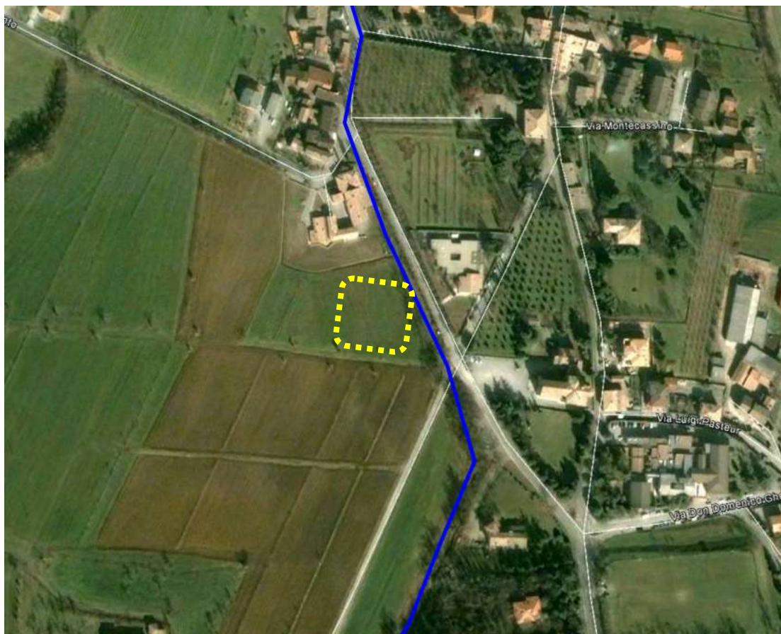
Figura 29 – Laminazione delle piene in un'area adibita all'accumulo delle acque, "acquisita" mediante servitù idraulica
