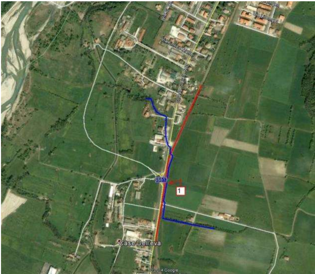
Figura 74 – Rio Fontaneto – Punto critico in cui sono segnalate problematiche idrauliche e idromorfologiche.
