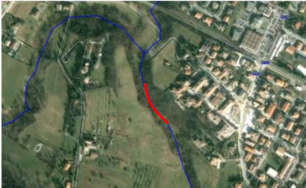
Figura 23 – Consolidamento del piede del versante mediante l’utilizzo di gabbioni rinverditi (in rosso) (localizzazione puramente indicativa).
