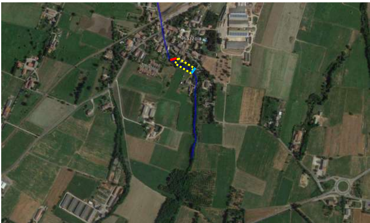
Figura 50 – Allargamento di sezione per la laminazione delle piene (in giallo), coadiuvato da una briglia a bocca tarata in chiusura dell'allargamento (in rosso) e trattenimento delle ramaglie mediante la realizzazione di una briglia selettiva (in azzurro).
