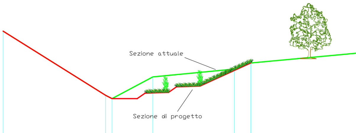
Figura 7 – Schema di massima di un intervento di sbancamento, abbassamento e riqualificazione dell'alveo. I terreni limitrofi al corso d'acqua e da questo idraulicamente disconnessi o connessi raramente sono ribassati per trasformarli in piana inondabile, allagabile con maggior frequenza e soggetta ai processi evolutivi geomorfologici ed ecologici. La nuova piana sarà ricreata a più livelli, in funzione degli obiettivi ecologici e idraulici perseguiti.
