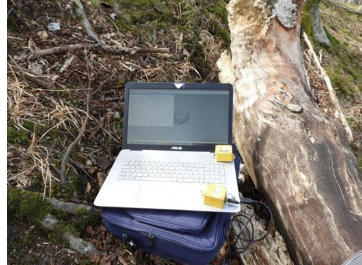
Scarico dati in campo dai data logger
